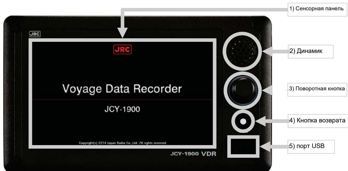
Рисунок 2-3 Название каждой части панели управления (ОРУ)
