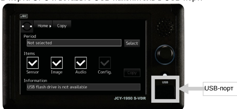
Рисунок 4-21 USB-порт блока OPU.
